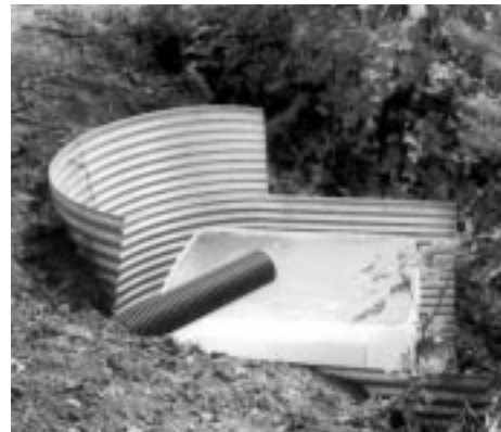
Figura 4. Tubo subterráneo y recipiente de recolección usado para medir la erosión del suelo.
